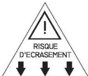
Mettre une distance suffisante avec les pièces des zones repérées lorsqu'elles sont en mouvement
