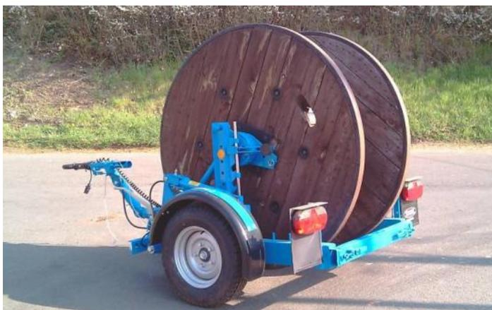
En position route, on peut transporter ou dérouler le touret. Un verrouillage mécanique évite que les vérins restent sous pression, gage de longévité.
