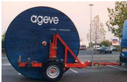
La remorque dérouleuse S 1500 L permet le chargement rapide d'un touret jusqu'au Ø 2,60 m (IBM) par l'action de vérins de poussée simple effet, alimentés par une pompe manuelle. Une vanne trois voies répartit le flux d'huile simultanément dans les deux vérins ou alternativement sur l'un ou l'autre, permettant d'obtenir l'horizontalité de l'axe du touret, même si le sol sur lequel reposent les roues de la remorque présente une importante différence de niveau.
