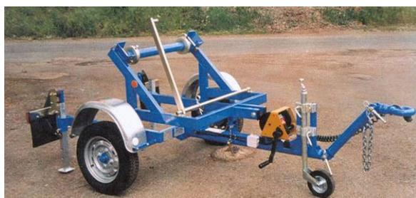
De conception simple et robuste, les dérouleuses S 504 permettent un chargement et déchargement rapide à l'aide d'un treuil à sangle (conforme à la norme NF E 52-095). Grâce aux deux béquilles arrière, une seule personne peut aisément basculer l'ensemble touret et support sans que la remorque soit attelée au véhicule tracteur.
