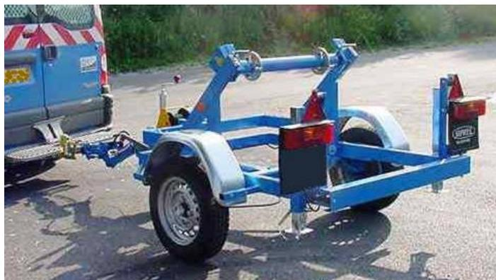
De conception simple et robuste, les dérouleuses S 505 permettent un chargement et déchargement rapide à l'aide d'un treuil à sangle (conforme à la norme NF E 52-095). Grâce aux deux béquilles arrière, une seule personne peut aisément basculer l'ensemble touret et support sans que la remorque soit attelée au véhicule tracteur.
