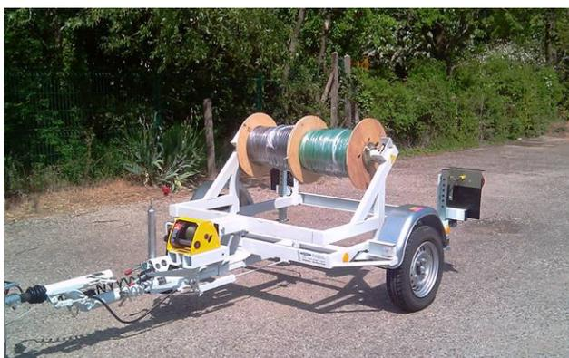
Extrapolée de la S 505, de conception simple et robuste, les dérouleuses S 505 L permettent un chargement et déchargement rapide à l'aide d'un treuil à sangle (conforme à la norme NF E 52-095). Grâce aux deux béquilles arrière, une seule personne peut aisément basculer l'ensemble touret et support sans que la remorque soit attelée au véhicule tracteur.
