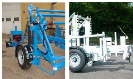
La dérouleuse S 2500 est une remorque polyvalente, capable de transporter et dérouler des tourets de tube polyéthylène de grand diamètre ainsi que des tourets de câble de masse importante. Les manutentions sont rapides et aisées grâce à deux vérins hydrauliques manœuvrables séparément pour faciliter le chargement d'un touret en dévers.
