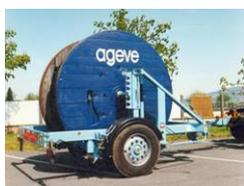
La dérouleuse S 5000 est une remorque polyvalente, capable de transporter et dérouler des tourets de tube polyéthylène de grand diamètre ainsi que des tourets de câble de masse importante. Les manutentions sont rapides et aisées grâce à deux vérins hydrauliques manœuvrables séparément pour faciliter le chargement d'un touret en dévers.
