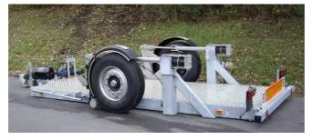
Si la remorque est dételée, le châssis repose complètement par terre.
